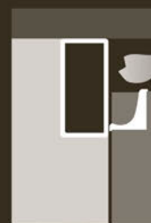
GOLA "DRITTA" CON MANIGLIA AD INCASSO / STRAIGHT GRIP WITH RECESSED HANDLE
